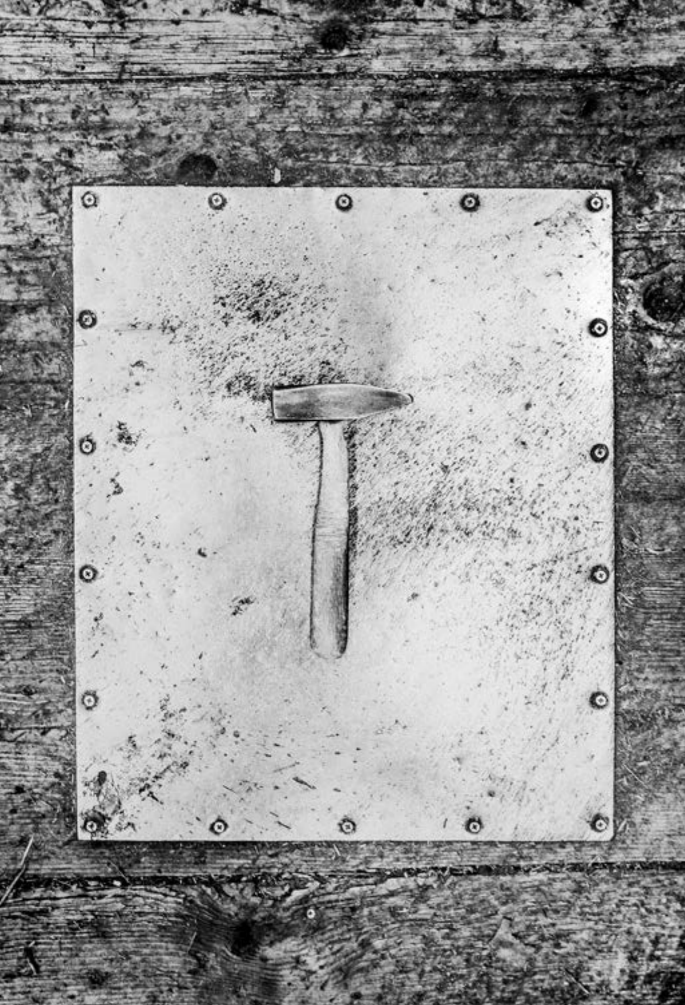
cz Kladio, které se používá pro zarážení klinů při ručním ohýbání en Hammer used to drive in wedges in manual bending de Hammer, der zum Einschlagen von Keilen beim Handbiegen verwendet wird pl Młotek do mocowania klinów w formach gięgarskich
